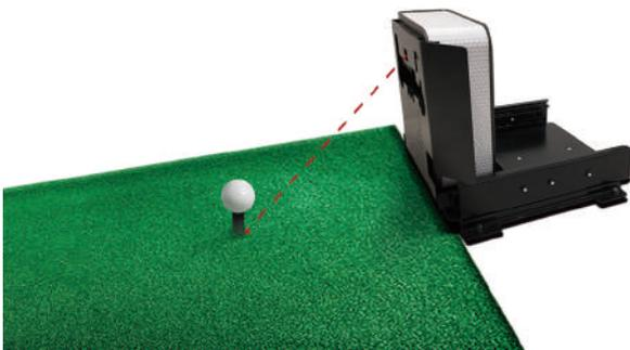
レールを本体側に押し、ティーの根元にレーザーを合わせてください。
